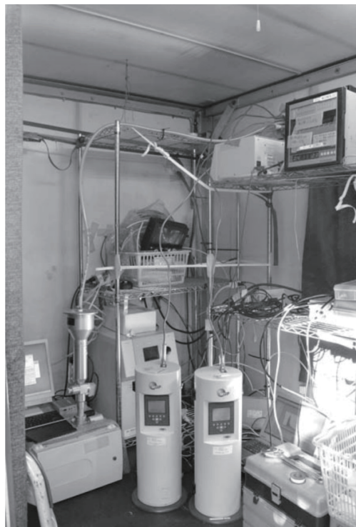
写真 3 川崎臨港警察署前交差点の観測小屋における粒子捕集 FRM サンプラー (左) NanoMOUDI II (右)
