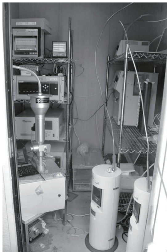
写真 4 中留公園の観測小屋における粒子捕集 FRM サンプラー (左) NanoMOUDI II (右)
