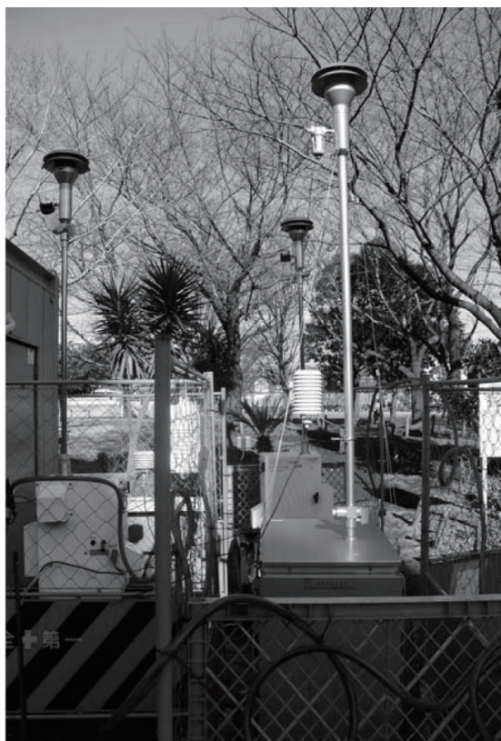
写真 4 中留公園の観測小屋における粒子捕集 FRM サンプラー (左) NanoMOUDI II (右)
