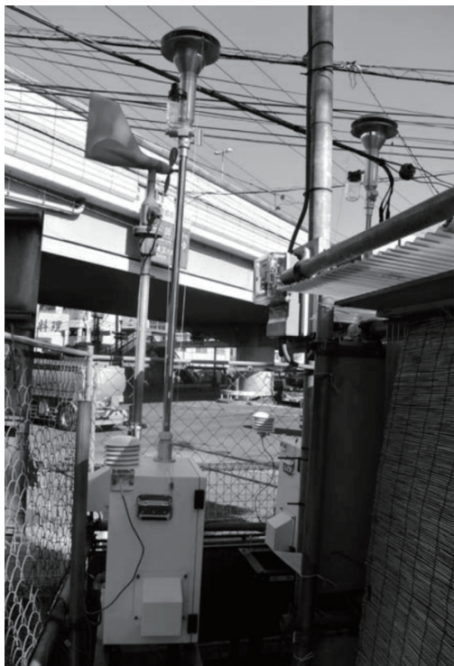
写真 3 川崎臨港警察署前交差点の観測小屋における粒子捕集 FRM サンプラー (左) NanoMOUDI II (右)
